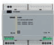
01901 Стереосулител 2 выхода для диффузоров звука 8 Ω 10+10 Вт, питание 110-230 В 50/60 Гц, встроенный ограничитель линии
