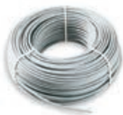
01840 Кабель для системы Bus, безгалогенный, 2x0,50 мм 2 , обеспечивает изоляцию от земли для номинального напряжения 400 В и, следова- тельно, пригодный для укладки в одном коробе с кабелями I категории, белая - 100 м
