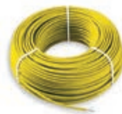
01840.Y Кабель для систем охранной сигнализации Bus 2x0,50 мм 2 , безгалогенный, обеспечивает изоляцию от земли для номинального напряжения 400 В и, следовательно, пригодный для укладки в одном коробе с кабелями I категории, цвет желтый - 100 м
