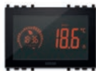
02955 Термостат с сенсорным экраном, управление температурой в режимах ON/OFF и PID, 1 вход для подключения датчика температуры, 1 многофункциональный вход, 1 вход RJ9 для подключения измерителя энергии (02960), перекидной релейный выход 5(2) А 230 В~ - 3 модуля. Глубина: 35,3 мм
