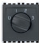
20096 Поворотный, 1П 6(3) А 250 В~, 4-позиции - 2 модуля. Глубина: 37 мм
