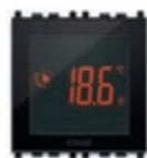
02950 Термостат с сенсорным экраном, управление температурой в режимах ON/OFF и PID, 1 вход для подключения датчика температуры, 1 многофункциональный вход, перекидной релейный выход 5(2) А 230 В~ - 2 модуля. Глубина: 38,5 мм
