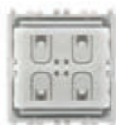
20505 Плоский пульт управления с двумя качающимися кнопками, радиопередатчик EnOcean без батарей, укомплектовывается специальными клавишами 20506 - 2 модуля. Глубина: 3,5 мм
