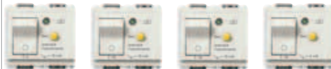
16511.06.B С 6, I Δn 10 mA, отключающая способность 1500 А - 2 модуля 16511.10.B С 10, I Δn 10 mA, отключающая способность 3000 А - 2 модуля 16511.16.B С 16, I Δn 10 mA, отключающая способность 3000 А - 2 модуля 16511.16.6.B С 16, I Δn 6 mA, отключающая способность 3000 А - 2 модуля
