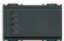
16926 Считыватель карт транспондера, вне комнаты, KNX EIB, 2 вх., 2 вых., HP 2 А 24 В~ выход реле - 3 модуля
